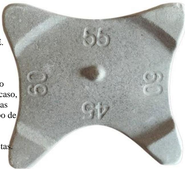
**MATERIAL DE FABRICACIÓN:** Estos separadores están fabricados con cemento **CEMEX II/B-LL 42.50 N**, con una dosificación mayor de 350 kg de cemento por m<sup>3</sup>, y una relación de agua por cemento a/c inferior a 0'45. El fraguado del hormigón se realiza en atmosfera controlada de humedad y temperatura.
