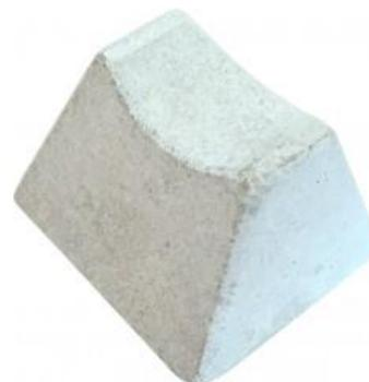
**CAMPO DE APLICACIÓN:** Separador de hormigón diseñado para uso en zonas horizontales. Se compone de un cuerpo de hormigón de forma cúbica, con una zona redondeada para ubicar la chapa de fijación; su función es la de apoyar y separar las armaduras, para que exista un recubrimiento homogéneo de estas, además de evitar desplazamientos durante el vibrado.
